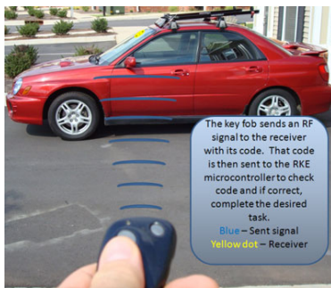
شکل ۳۴-۲ سیستم کنترل ماشین با سنسور RF
