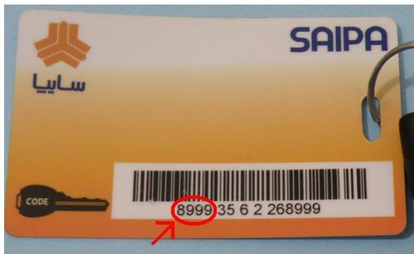
✓ با وجود شباهت ظاهری کلید در سیستم زیمنس و ولئو، ترانسپوندر (تراشه داخل کلید) سیستم ولئو، قابلیت تعریف برای سیستم زیمنس و بلعکس را ندارد، بنابراین میبایست در هنگام تعویض کلید، با توجه به نوع سیستم ایموبیلایزر خودرو به نوع ترانسپوندر دقت نمایید.
