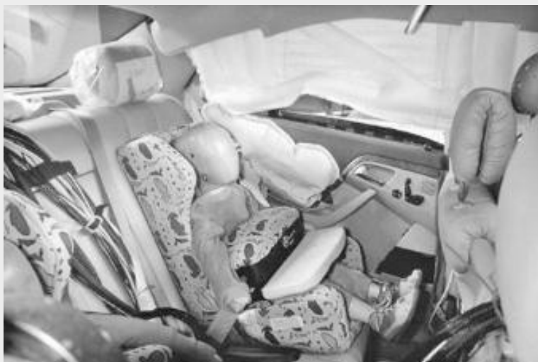
شکل ۱۰: نحوه قرارگیری کودک در خودرو به هنگام تست کودک
