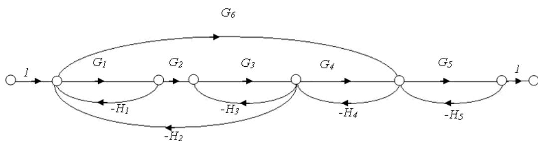
$$\frac{G_1 G_2 G_3 G_4 G_5 + G_6(I + G_1 H_1 + G_3 H_3 + G_4 H_4 + G_1 G_4 H_1 H_3 + G_1 G_4 H_1 H_4) + G_1 G_5 H_1 H_5 + G_1 G_5 H_1 H_5 + G_1 G_2 G_4 G_5 H_2 H_5 + G_1 G_2 G_5 H_1 H_2 H_5}{I + G_1 H_1 + G_3 H_3 + G_1 G_2 G_3 H_2 + G_4 H_4 + G_5 H_5 + G_1 G_3 H_1 H_4 + G_1 G_4 H_1 H_4}$$
