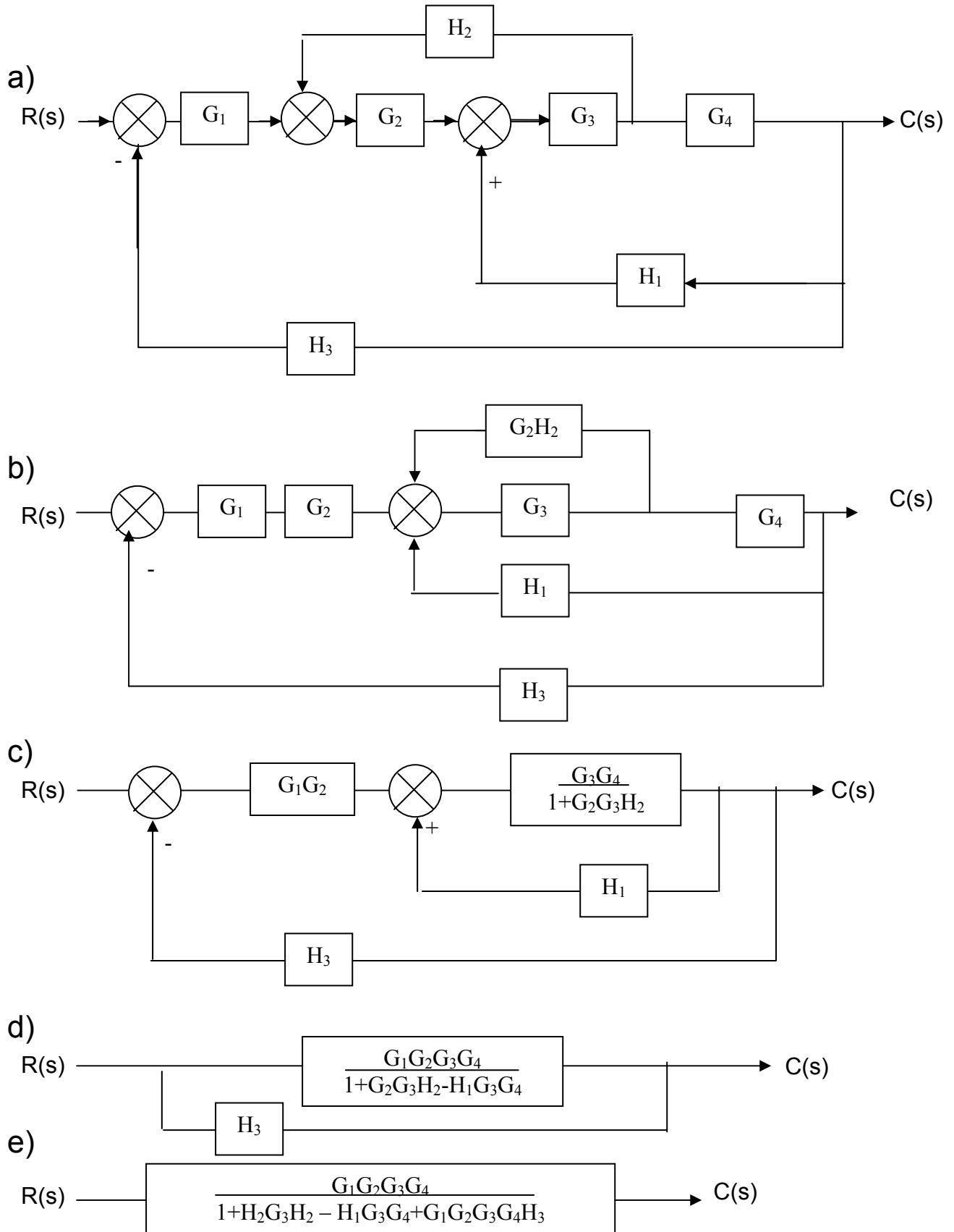
۸) شکل زیر یک دیاگرام بلوکی سیستم خطی فیدبک دار را نشان می‌دهد.تابع تبدیل آن را بدست آورید.
