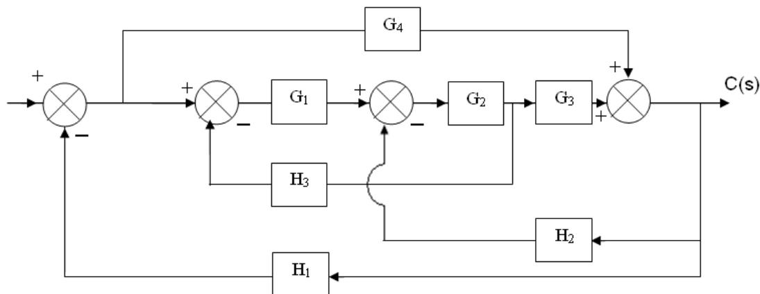
$$\frac{G_1 G_2 G_3 + G_4}{I + G_1 G_2 G_3 H_1 + G_1 G_2 H_3 + G_2 G_3 H_3 + G_4 H_1 - G_2 G_4 H_2 H_3}$$
