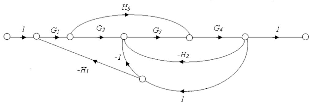
$$\frac{G_1 G_2 G_3 G_4 + G_1 G_4 H_3}{I + G_3 G_4 + G_3 G_4 H_2 + G_1 G_4 H_1 H_2 + G_1 G_2 G_3 G_4 H_1}$$
