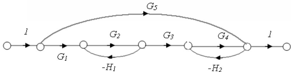
$$(a) \frac{G_1 G_2 G_3 + G_4(I + G_2 H_4)}{I + G_2 H_1}$$
