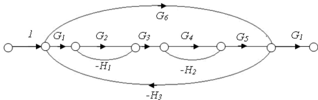
$$\frac{G_1 G_2 G_3 G_4 G_5 + G_6(I + G_1 H_1 + G_4 H_2 + G_2 G_4 H_1 H_2)}{I + G_1 H_1 + G_4 H_2 + G_1 G_2 G_3 G_4 G_5 H_1 + G_6 H_1 + G_2 G_4 H_1 H_2 + G_1 G_6 H_1 H_3 + G_4 G_6 H_2 H_3}$$
