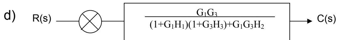
۴) تابع تبدیل سیستمی که بلوک دیاگرام آن به شکل زیر است را تعیین کنید.
