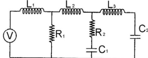
۴) مدار الکتریکی سیستم زیر را به دو روش T-V و T-i رسم کنید.
