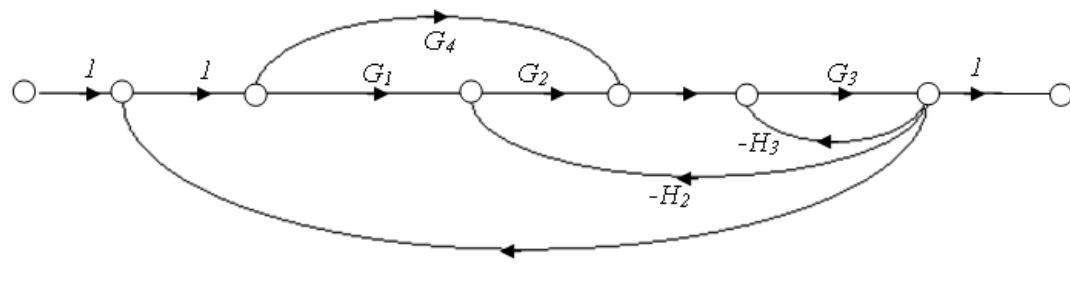
$$\frac{(G_1 G_2 + G_4) G_3}{I + G_1 G_2 G_3 H_1 + G_4 G_3 H_1 + G_2 G_3 H_2 + G_3 H_3}$$
