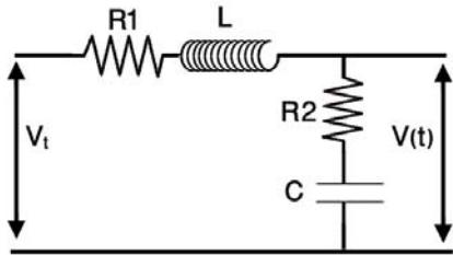
$$\begin{bmatrix} I & R_I \\ 0 & I \end{bmatrix} \begin{bmatrix} I & LD \\ 0 & I \end{bmatrix} \begin{bmatrix} \frac{I}{CD} & 0 \\ \frac{RCD + I}{CD} & I \end{bmatrix}$$
