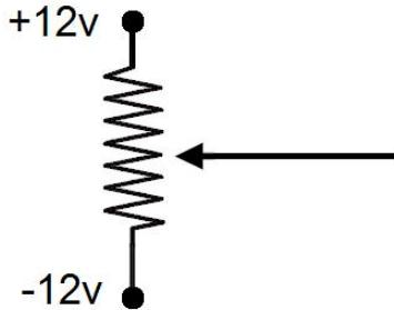
$$(i) \text{ ثابت } k_p \text{ پتانسیومتر } \frac{\text{v}}{\text{Rad}}$$
