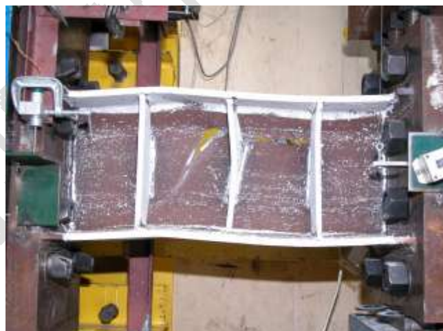
شکل ۶- ۲۱ آزمایش تیر پیوند برای برش [12]
