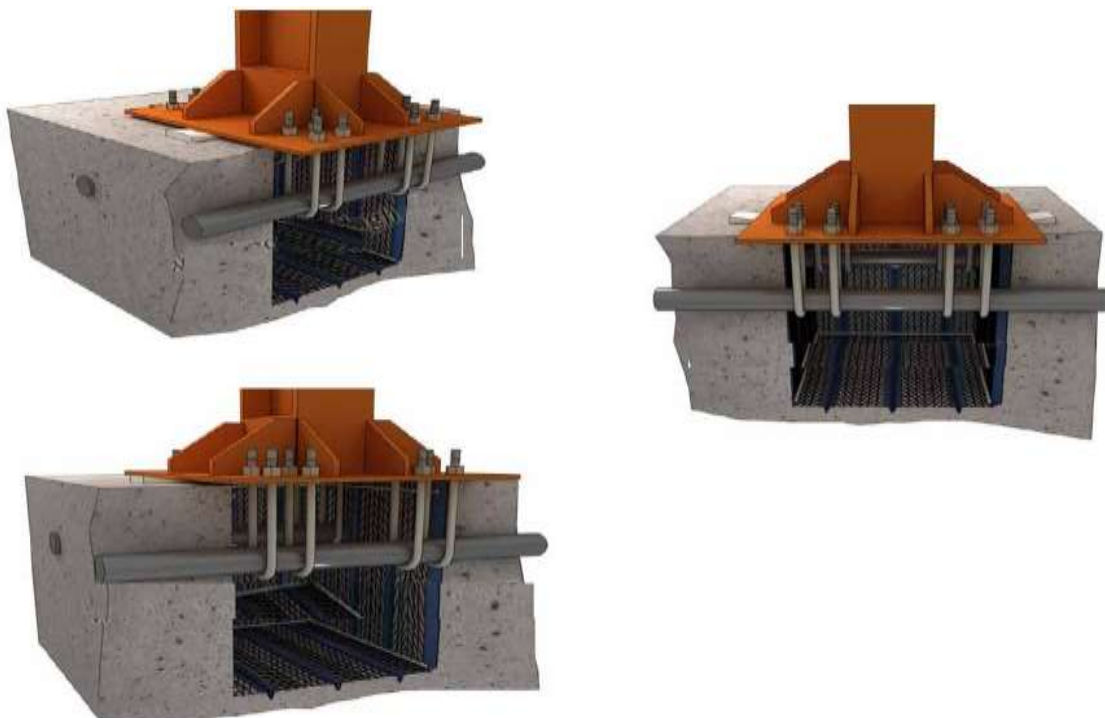
چند نمای گوناگون از وضعیت قرار گرفتن و نصب ستون به فونداسیون
