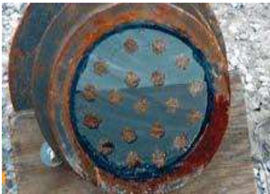
گروت تزریق شده داخل گیره
