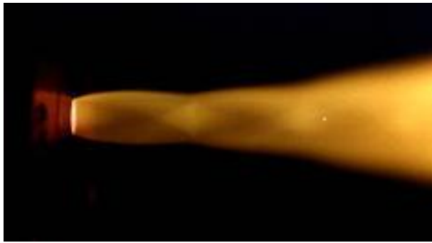
شکل ۵- نمایش امواج انبساطی و تراکمی در خروجی نازل
