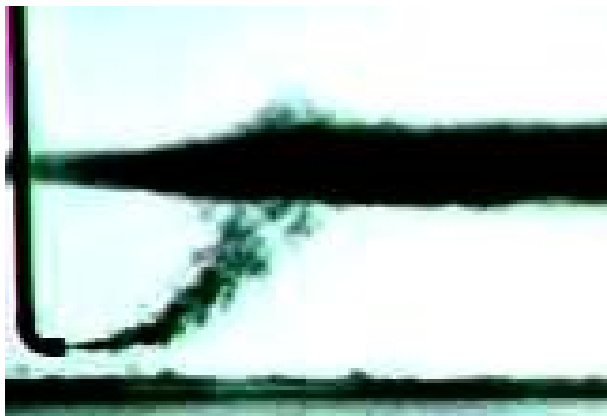
شکل ۷- اثر گرانش بر روی جریان گاز در خروجی از لوله
