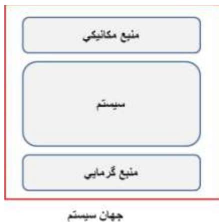
شکل ۱-۵. سیستم و منبع‌های گرمایی و مکانیکی در ارتباط با آن
