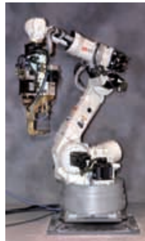
(ث) روبات جوشکار، جوش مقاومتی
