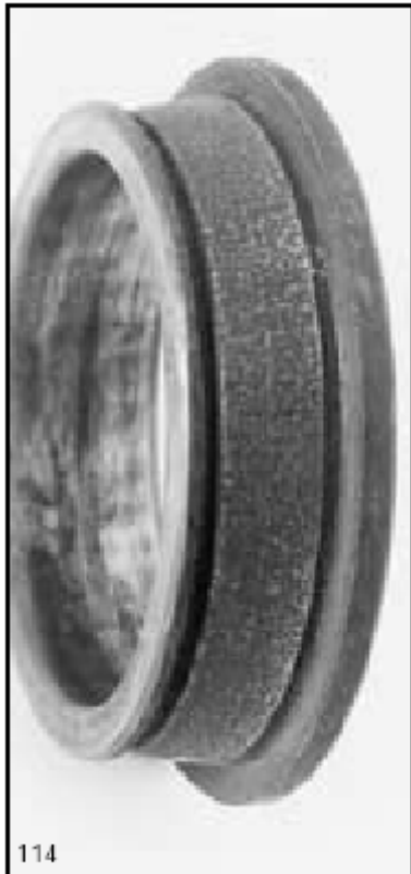
شکل ۲۰ - شیارهای غیر عادی روی رینگ
