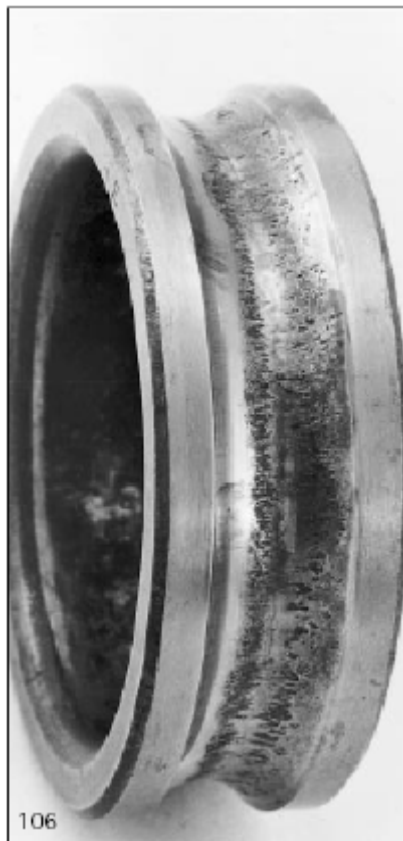
شکل ۱۱ - خرابی در رینگ داخلی یک یاتاقان شیار عمیق
