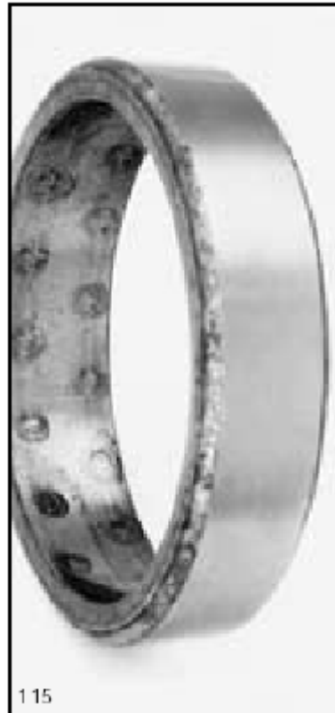
شکل ۱۹ - خوردگی در یاتاقان مخروطی داخلی یاتاقان ثابت
