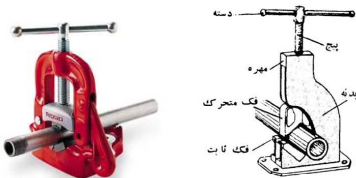
شکل ۱-۲ گیره مخصوص لوله کشی
