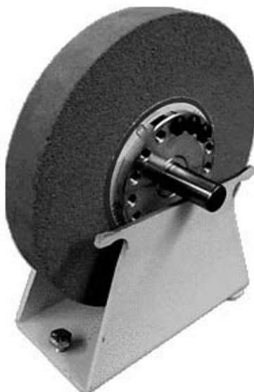
شکل ۷-۷ بالانس کردن سنگ
