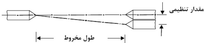
شکل ۳۴-۴ روش مخروط تراشی با انحراف مرگک
