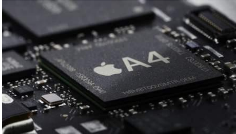
شکل ۱.۲ - پردازنده Apple A4 به کار رفته در iPad، iPhone 4 و نسل چهارم iPod Touch
