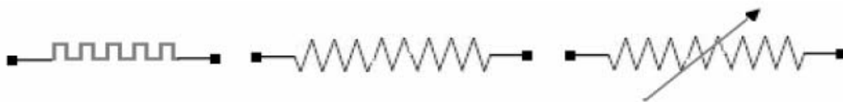
شکل (۱۵): شماتیک مقاومت الکتریکی در مدارها
