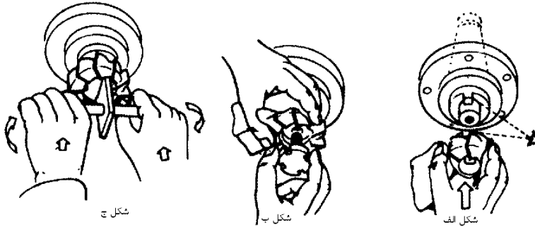
شکل ۱۸-۵ روش بستن تیغه فرزها
