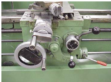
شکل ۴-۵ دستگاه حرکت پیشروی و بار
