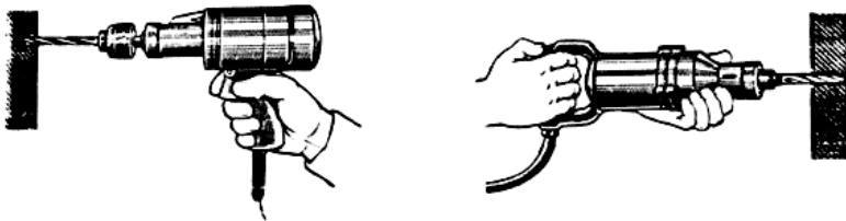
شکل ۹-۲ انواع ماشین‌های مته دستی و روش کار با آنها
