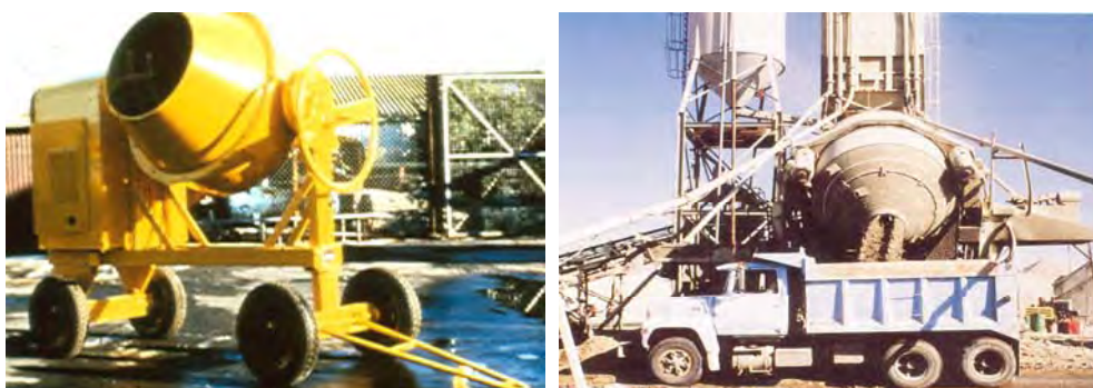
شکل ۲ انواع مخلوط‌کن‌های کج شونده
