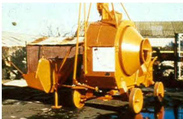
شکل ۳ یک نمونه مخلوط‌کن غیر کج شونده
