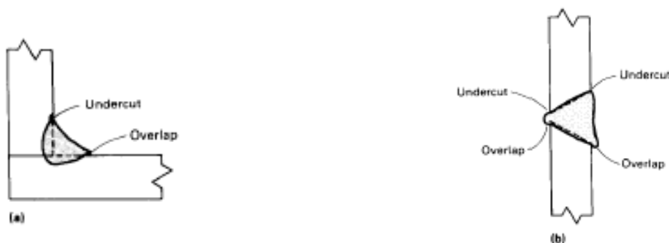
شکل ۹- بریدگی کناره جوش در جوشهای گوشه ای (a) و جوشهای نفوذی سربه سر (b)
