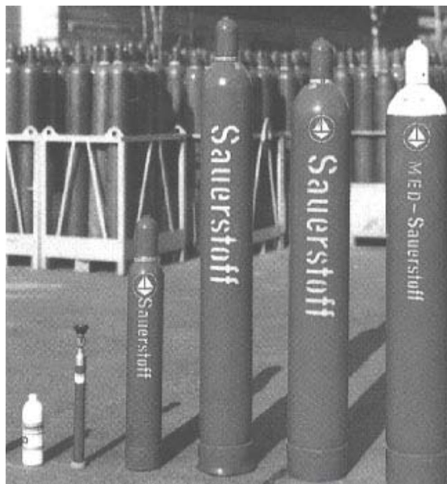
شکل ۴. کپسولهای ذخیره اکسیژن
