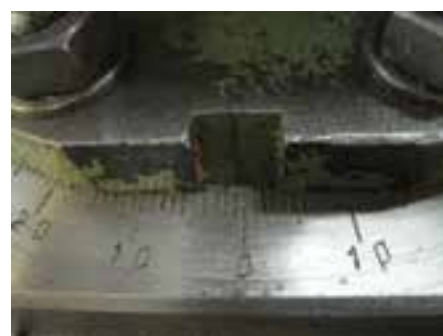
شکل ۶-۷ درجه بندی زیر سوپرت فوقانی
