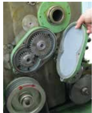
شکل ۱۳-۱ چرخ‌دنده‌های Z_1 و Z_2
