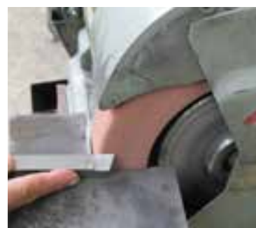
شکل ۴-۱۰ تیز کردن زاویه آزاد بغل
