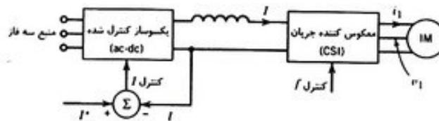
این موتور چهار قطبی بوده و سرعت اسمی آن ۱۷۴۰ دور در دقیقه است. جریان فاز موتور موج شبه چهار گوش با پهنهای ۱۲۰ درجه می باشد.
